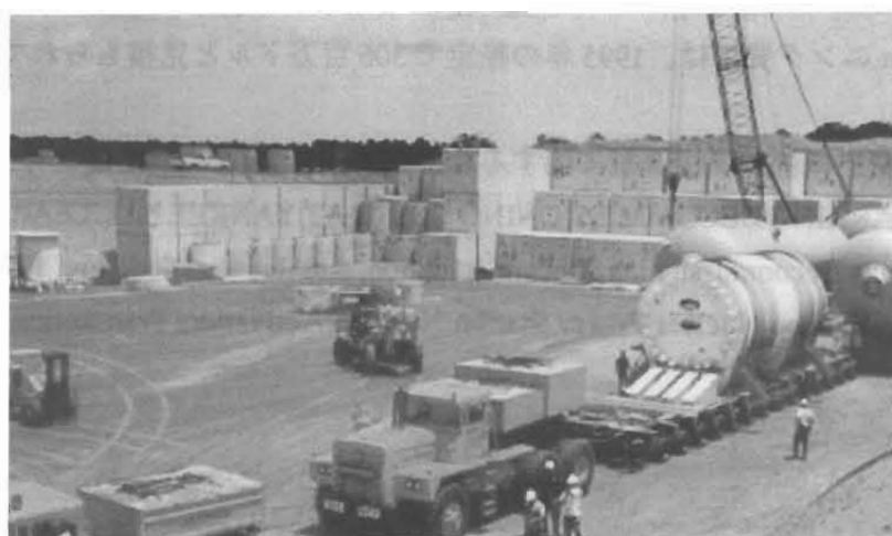
処分場に到着した原子炉圧力容器
